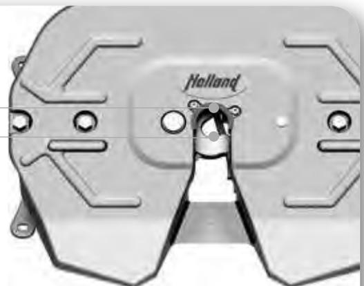
Für ein leichtgängiges Drehen und um den Verschleiß zu mindern, muss die Sattelplatte mit Fett geschmiert werden. Dabei sorgen spezielle Schmiernuten in der Sattelkupplungsplatte dafür, dass das Schmierfett besser verteilt wird und möglichst lange haftet.
