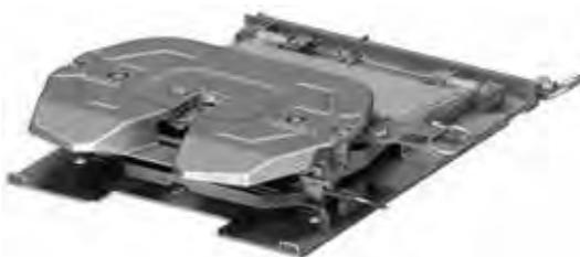
Diese Sattelkupplung wurde speziell für den Volumentransport mit zwei-achsigen „Low-Liner-Fahrzeugen“ und „Mega-Trailern“ entwickelt. Die höhenverstellbare Sattelkupplung erlaubt das Anheben der Hubvorrichtung mit Druckluft vor dem Aufsatteln, sodass Sattelaufleger mit unterschiedlichen Kupplungshöhen von ein und derselben Zugmaschine gezogen werden können. Die Hub-Sattelkupplung ist vorgebohrt erhältlich, die für alle europäischen Fahrzeuge passen.
