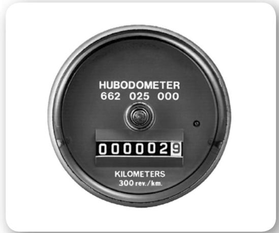
Die Präzisions-Hubodometer sind für alle gängigen Reifengrößen von 15" bis 22,5" erhältlich.
