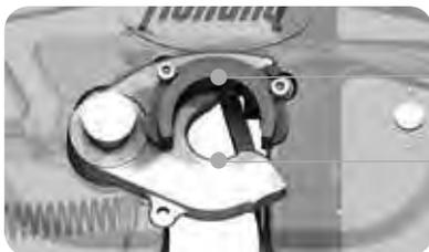
**Die Kontaktfläche des Verschleißrings muss das „Schieben“ abfangen (C)**
